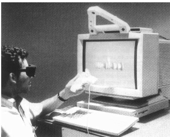
Slika 18: Logitech 6DOF – ultrazvučni uređaj za praćenje
