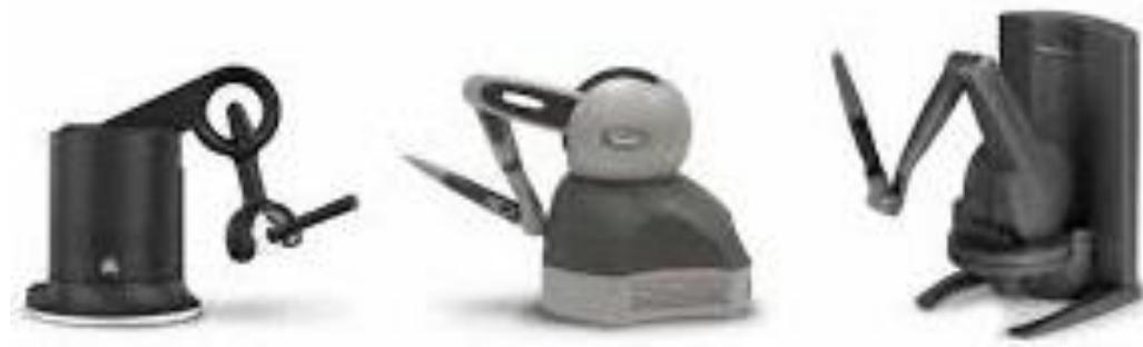
**Slika 22: Geomagic haptički izlazni uređaji virtualne stvarnosti**
