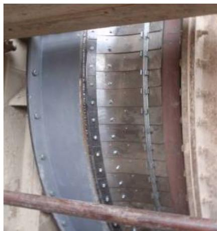
**Slika 17: Brtva rotacijske peći**
