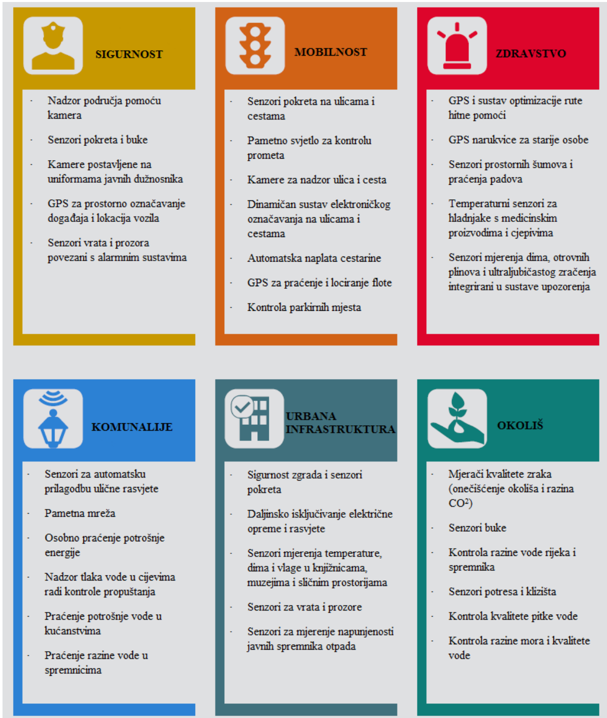
Slika 4 Područja uporabe i primjene senzora
