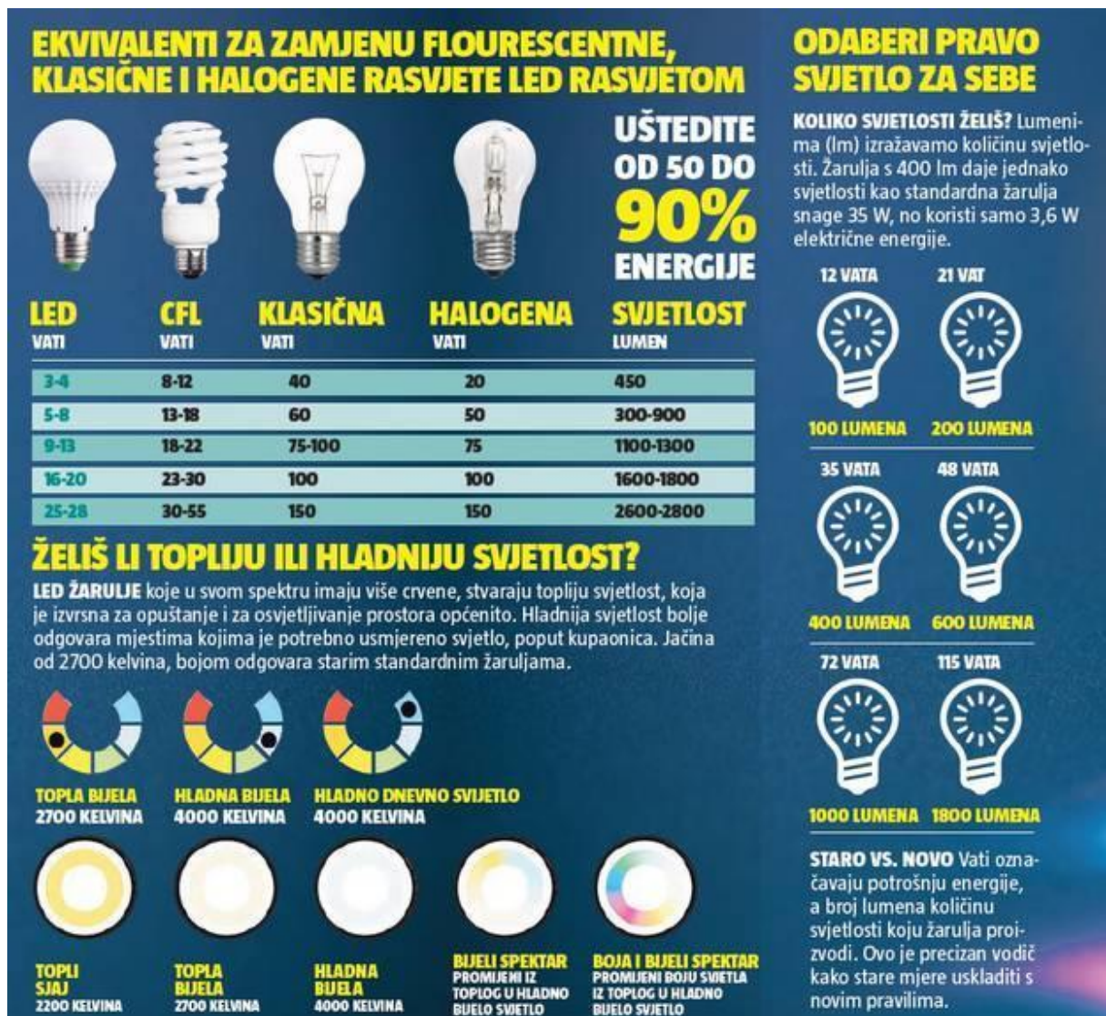
Slika 27: Usporedba najčešće korištenih žarulja u smještajnim jedinicama
