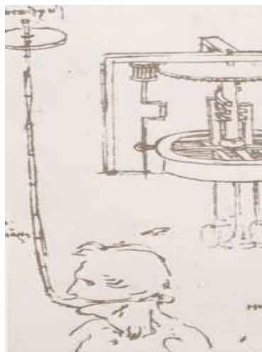
Slika 1: Prikaz da Vincijevog uređaja za ronjenje u plitkoj vodi
