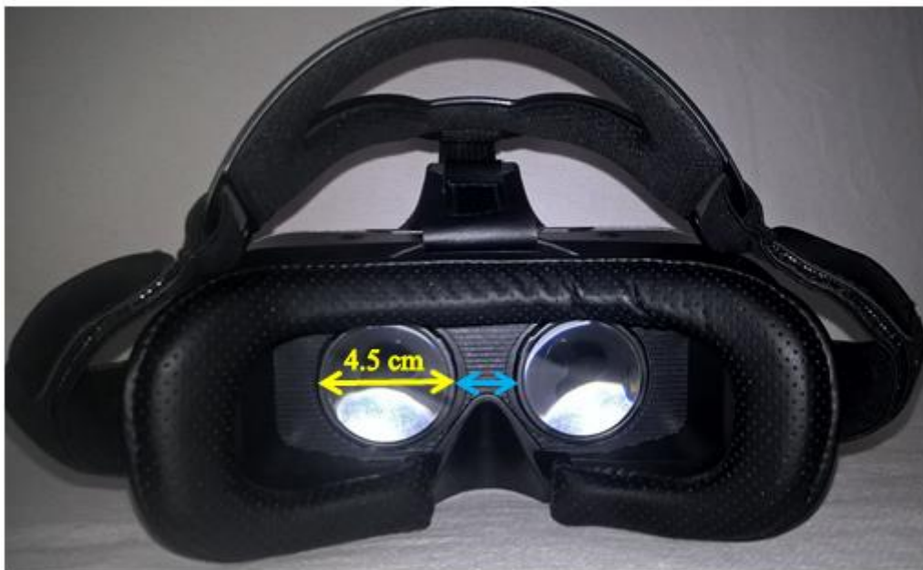
Slika 62: Unutarnja strana Shinecon VR G02 Headset uređaja
