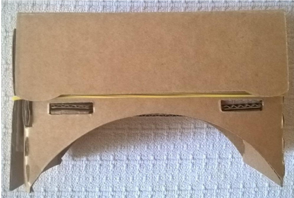
Slika 42: Gornja strana VR Cardboard uređaja (zatvoreni pretinac)
