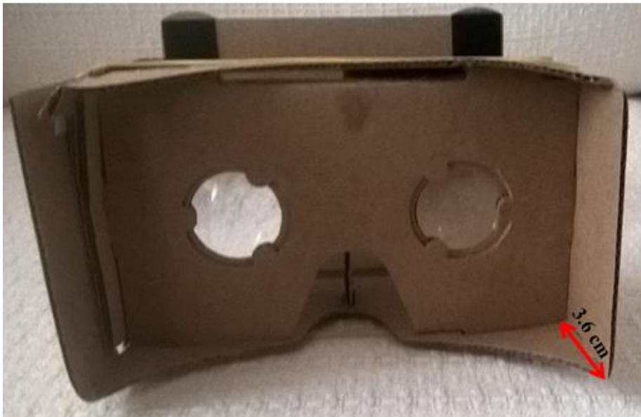
Slika 45: Unutarnja strana VR Cardboard uređaja
