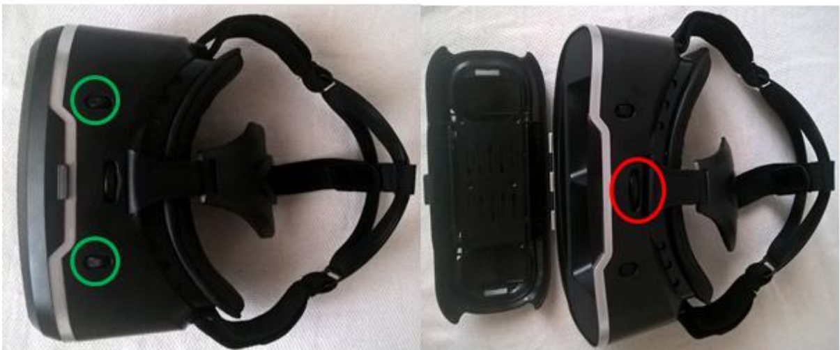
Slika 63: Gornja strana Shinecon VR G02 Headset uređaja
