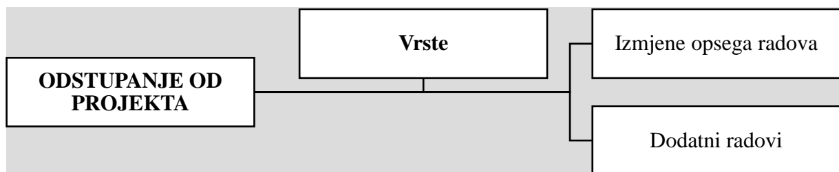
Slika 16: Vrste odstupanja od projekta
