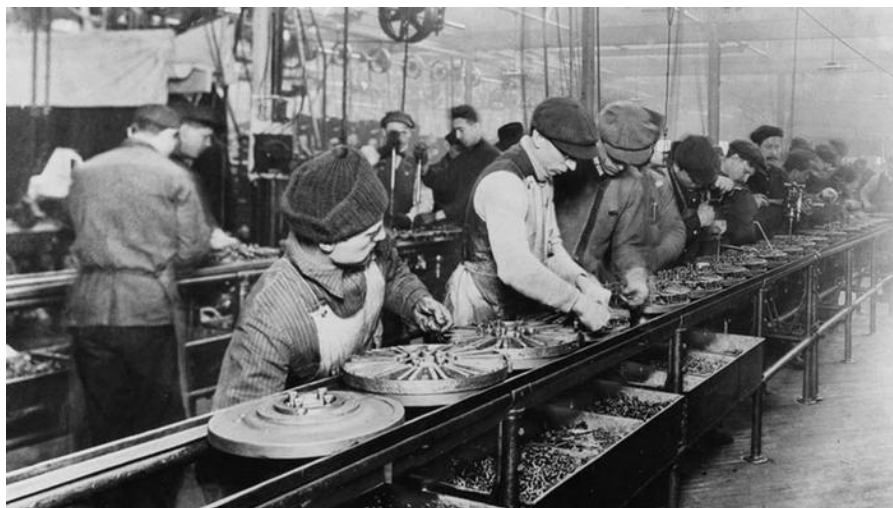
Slika 4: Pokretna traka Henryja Forda koja je uvela revoluciju u industrijsku proizvodnju
