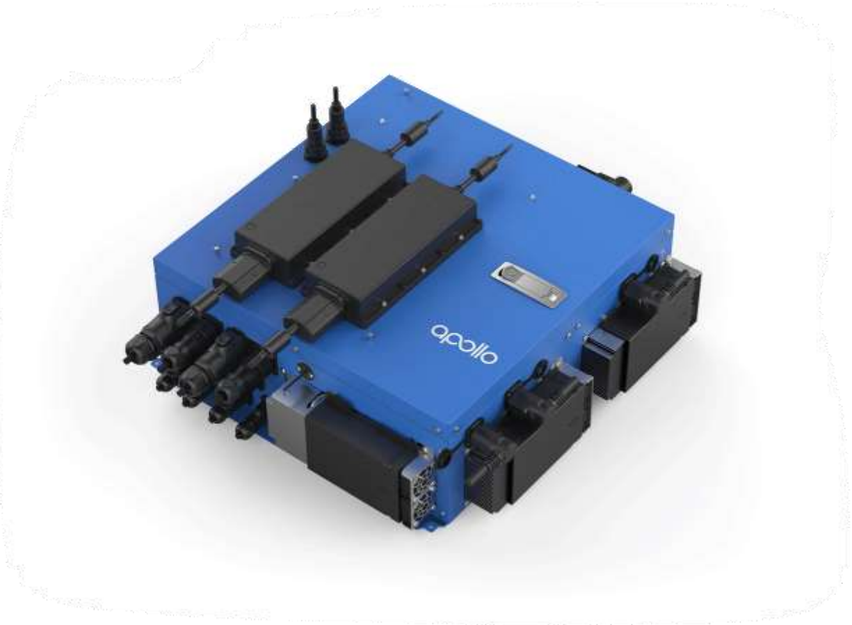
Slika 5 Apollova interno razvijena računalna jedinica
