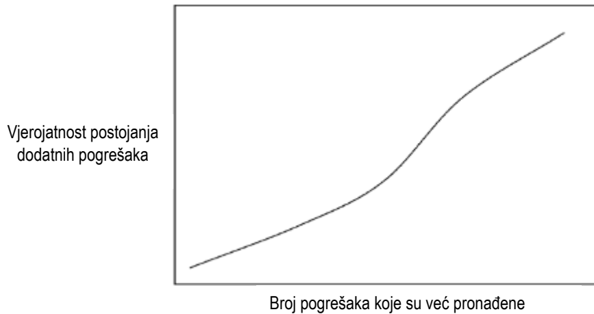
Slika 3.2.1. Proporcionalnost već pronađenih pogrešaka u softveru i onih koje još nisu pronađene
