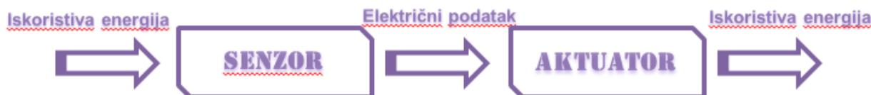
**Slika 2: Prikaz rada senzora i aktuatora**
