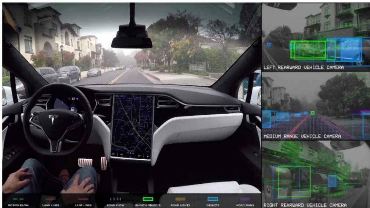
Slika 25. Prikaz što Teslin „autopilot vidi“ a vrijeme vožnje.
