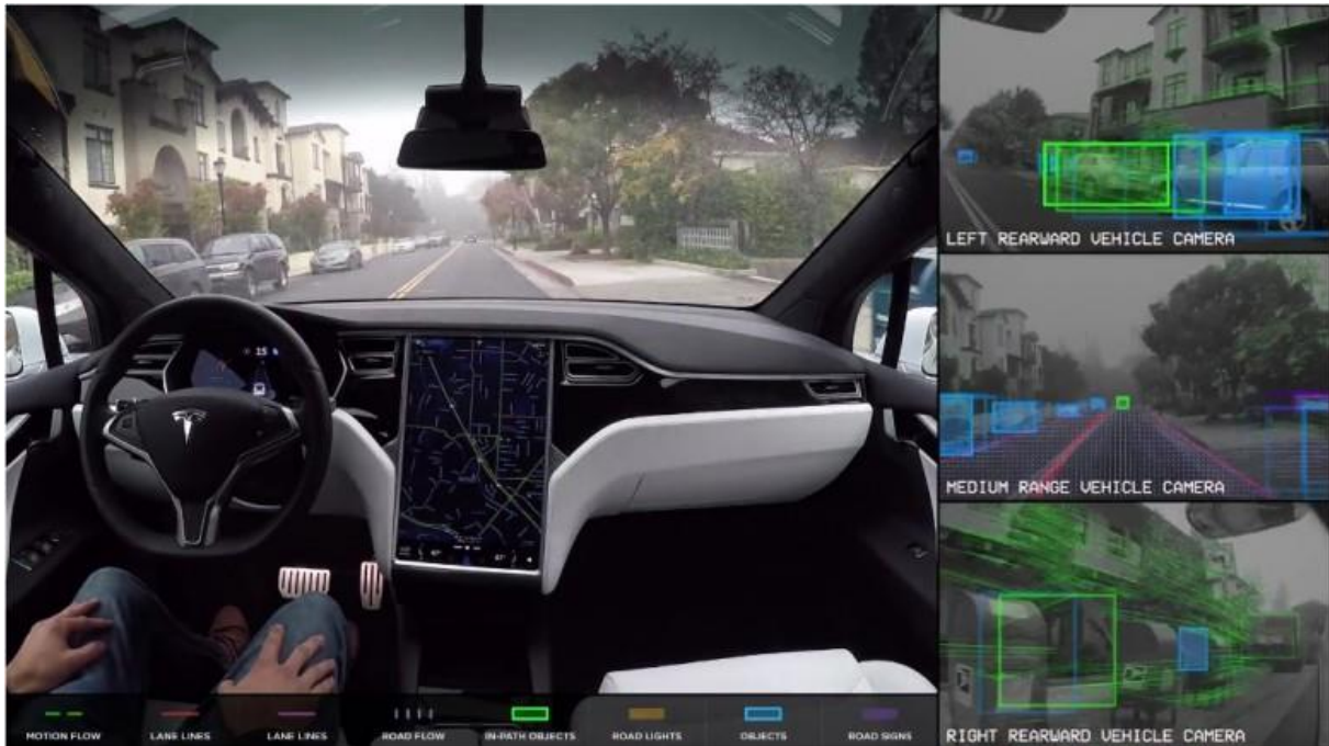
Slika 25. Prikaz što Teslin „autopilot vidi“ a vrijeme vožnje.
