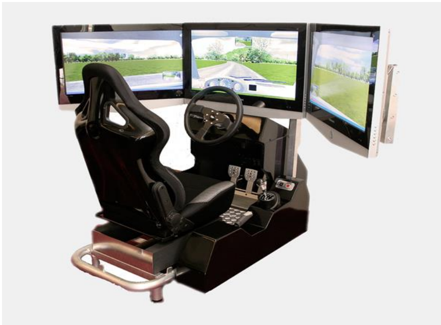
Slika 3. Primjer polu-imerzivnog sustava virtualne vožnje automobila
