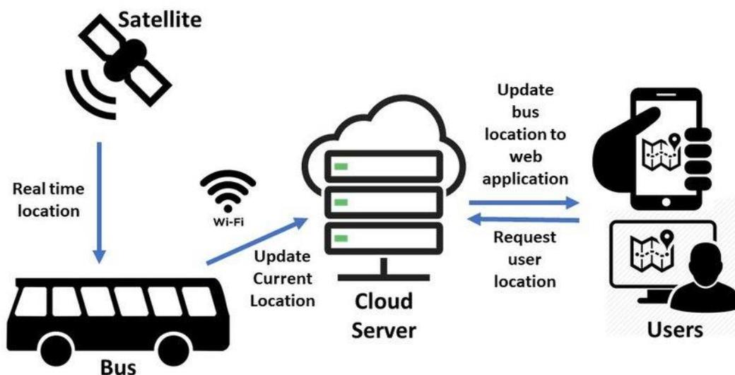
**Slika 8 : Način funkcioniranja sustava za praćenje vozila u stvarnom vremenu**
