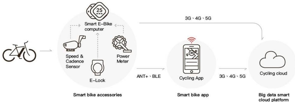
**Slika 13 : Način funkcioniranja sustava za dijeljenje bicikla**
