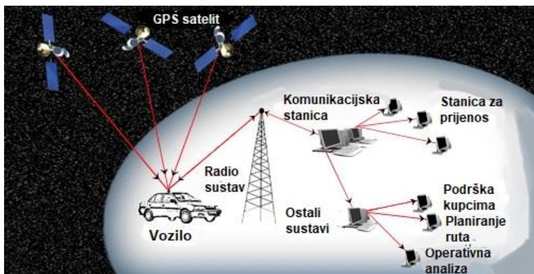
**Slika 3: Sistem funkcioniranja AVL baziranog na GPS-u**
