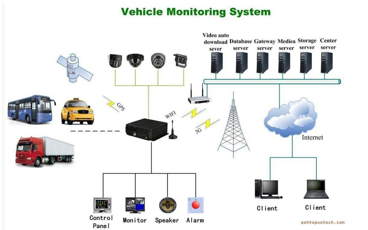
**Slika 9 : Način funkcioniranja sustava sigurnosnih kamera**
