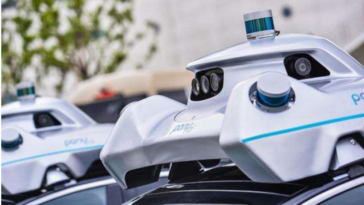
Slika 6 PonyAlpha hardverski senzor
