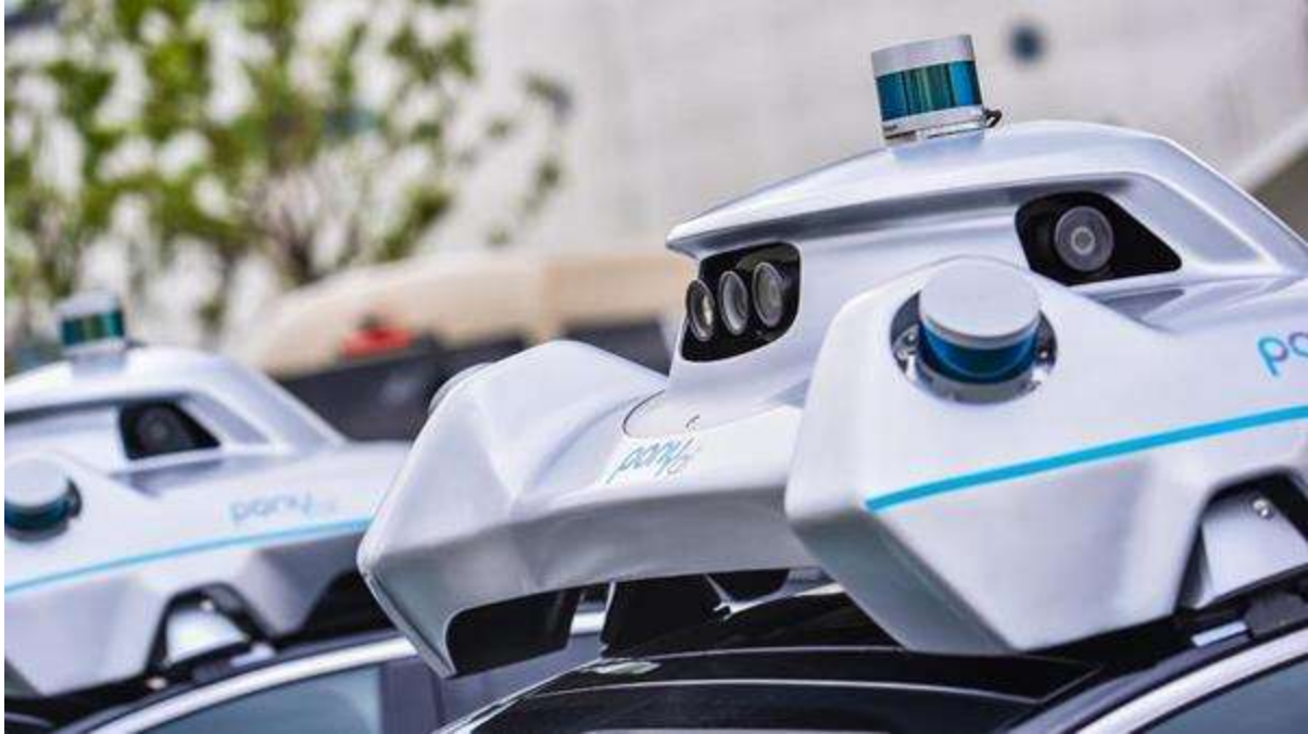
Slika 6 PonyAlpha hardverski senzor
