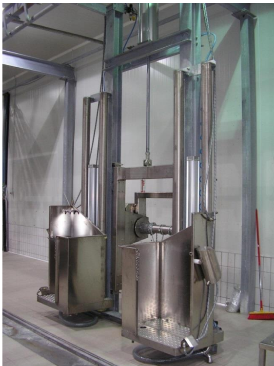
Slika 9: Pneumatski stroj za skidanje kože goveda
