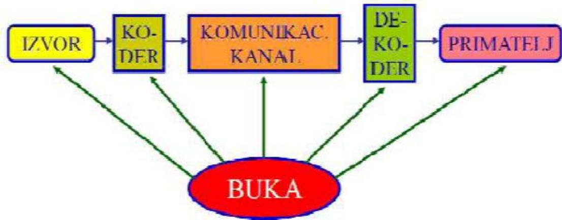
**Slika 1. Model komunikacijskog sustava**
